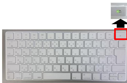
図5 キーボードのスイッチ(ON状態)
